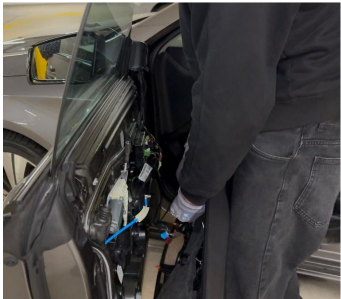
Abb. 1: Ausbau der Türverkleidung
